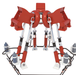
Устройство регулировки измельчающих роликов
